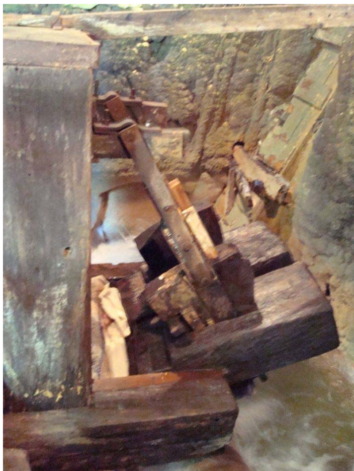
Fig.2. Maillets et piles du foulon du Parc national de Krka en Croatie (source : Wikipédia)
